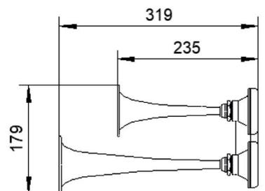
Bei Verwendung von Schneeschutzkappen erhöht sich die Gesamtlänge der Becher um 30 mm.
