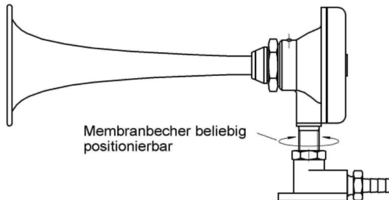
Durch unseren neu entwickelten Halter aus Aluminium eloxiert wird die Montage vereinfacht. Die Becher können von einer Seite montiert und in jeder Richtung fixiert werden. Der Halter ist auch mit den Winkelanschlussstücken Art.-Nr.: 2568.14 kombinierbar. Um Einbauhöhe einzusparen kann der Gewindestutzen um 15mm gekürzt werden (Späne im Membrangehäuse vermeiden).
