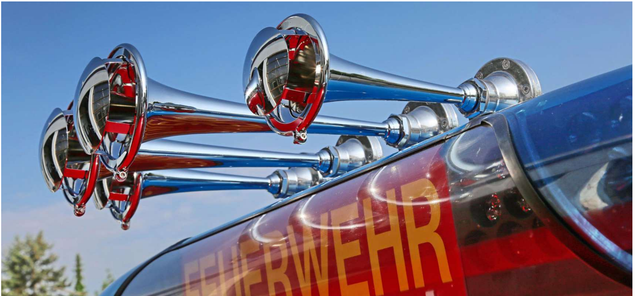
Chromglänzender Champion im Dezibel-Universum: Das Martinshorn mit vier Schallbechern erzeugt durchdringende und gut ortbare Warnsignale, das berühmte „Tatütata“. Foto: Jörg Lantelme/Adobe Stock
