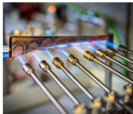
Das Lötten gehört zu den wesentlichen Arbeitsschritten beim Herstellen von Martinshörnern. Fotos: Deutsche Signal-Instrumenten-Fabrik
