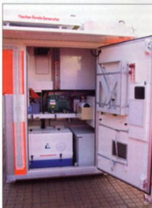
**Technikraum:** An der Stirnseite des Wechselaufbaus im Technikraum sind Diesel-Stromerzeuger sowie Klima- und Lüftungstechnik untergebracht.
