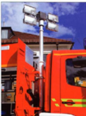
„RW München 1“: Der pneumatische Lichtmast mit vier Scheinwerfern ist an der Aufbausäule montiert.
