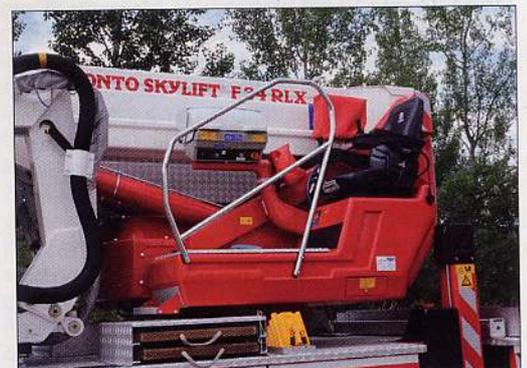
**Bedienstand:** Das neue Kombifahrzeug der Werkfeuerwehr Bosch Rexroth verfügt über eine Hubrettungskomponente sowie eine umfangreiche Löschtechnik. Der Bedienstand der Hubrettungsbühne „F34RLX“.
