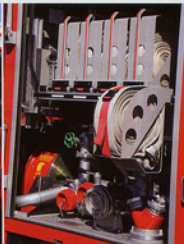
links: Im Geräteraum G1 kann ein Wechselcontainer – hier der Container mit den Hebekassen – eingeschoben werden. mitte: Durch Schwenkmodule kann eine Geräteablage auch in der Mitte des Aufbaus erfolgen. Im Geräteraum G2 werden beispielsweise der tragbare 13-kVA-Stromerzeuger, der Wasser-/Staubgutsauger und der Beleuchtungssatz mitgeführt. rechts: Über dem Pumpenbedienstand werden B- und C-Druckschläuche gelagert.
