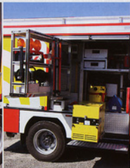
links: Im Geräteraum G1 kann ein Wechselcontainer – hier der Container mit den Hebekassen – eingeschoben werden. mitte: Durch Schwenkmodule kann eine Geräteablage auch in der Mitte des Aufbaus erfolgen. Im Geräteraum G2 werden beispielsweise der tragbare 13-kVA-Stromerzeuger, der Wasser-/Staubgutsauger und der Beleuchtungssatz mitgeführt. rechts: Über dem Pumpenbedienstand werden B- und C-Druckschläuche gelagert.
