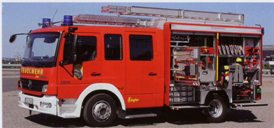
Die Werkfeuerwehr achtete auf eine möglichst niedrige und damit ergonomische Entnahmehöhe der Geräte: So wurden auch die Schlauchtragekörbe im tiefgezogenen Bereich des Geräteraums G1 verlastet.
