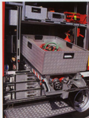
links: Im Geräteraum G1 kann ein Wechselcontainer – hier der Container mit den Hebekassen – eingeschoben werden. mitte: Durch Schwenkmodule kann eine Geräteablage auch in der Mitte des Aufbaus erfolgen. Im Geräteraum G2 werden beispielsweise der tragbare 13-kVA-Stromerzeuger, der Wasser-/Staubgutsauger und der Beleuchtungssatz mitgeführt. rechts: Über dem Pumpenbedienstand werden B- und C-Druckschläuche gelagert.
