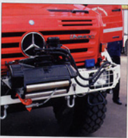
Selbstbergung: Die Frontschielwinde von Werner am Fahrzeug der FF Forst hat eine Länge von 45 m.
