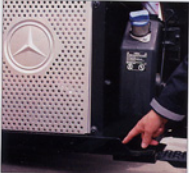
Unterbodenschutz: Unter dem Tank schützen zusätzliche Bleche vor mechanischer Beschädigung.
